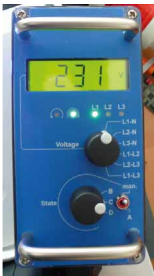
Messung der Spannung L1 zu N Rechtsdrehendes Feld
